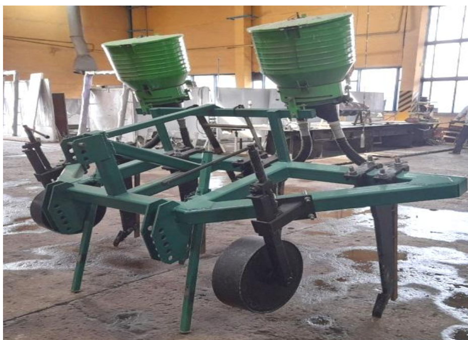
2-расм. Анор қатор ораларини тупроқларини чуқур юмшатиладиган ва илдизларини кесадиган, ўғитни кенг тасмасимон усулда соладиган машина
